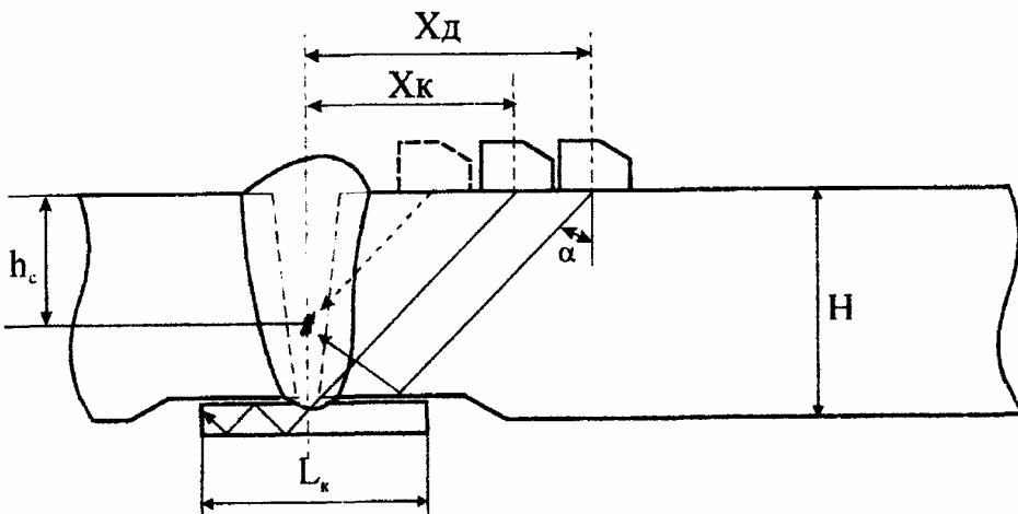
Пунктиром обозначены путь УЗ луча и положение эхо-сигнала
